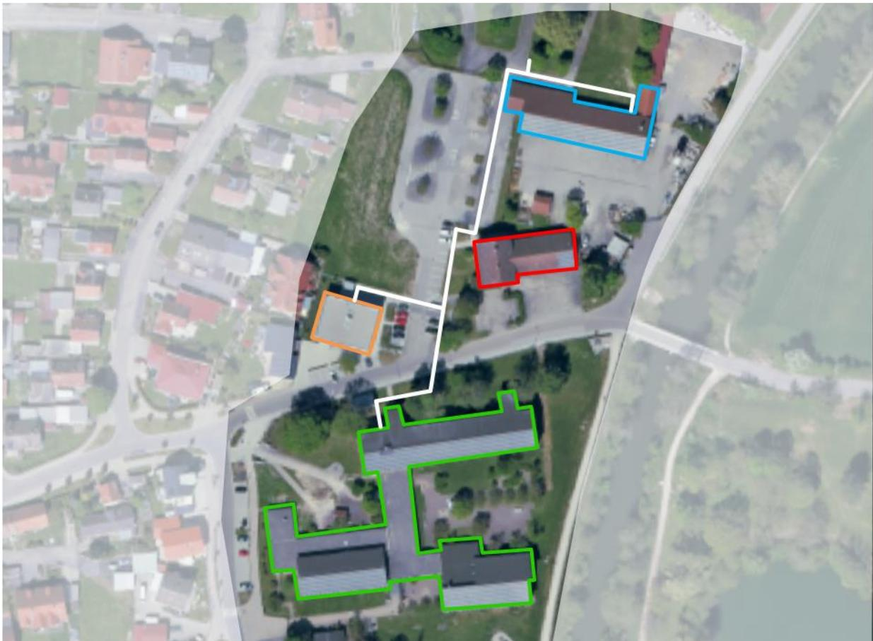
**Abbildung 4: Nahwärmeverbund - Heizzentrale in Grundschule (grün) speist das Nahwärmenetz (weiß). Angeschlossene Verbraucher: Gesundheitszentrum (orange), Feuerwehr (rot) und Bauhof (blau). Anschluss für Schulsport vorbereitet (nördlichster Punkt Nahwärmenetz), Luftbild Datenquelle: Bayerische Vermessungsverwaltung - [www.geodaten-bayern.de](http://www.geodaten-bayern.de)**
