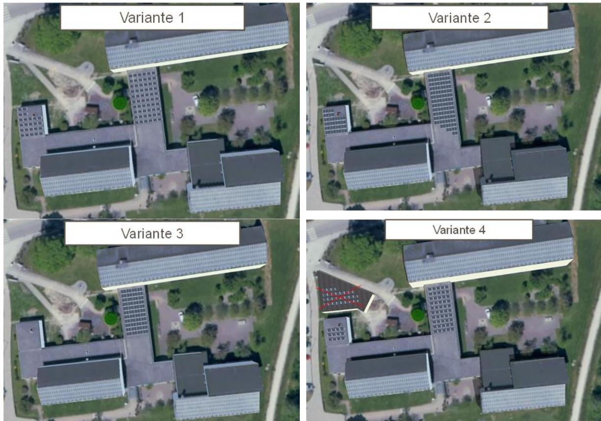
Abbildung 43: PV-Simulationsmodelle der Varianten 1 bis 4, Grundschule Baar-Ebenhausen
